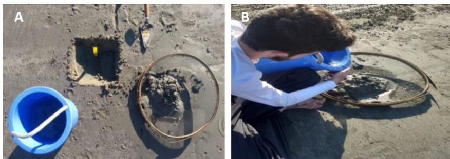
**Figura 9.2** – A) Quadrante escavado e B) água despejada na areia para sobrar os *pellets*.
